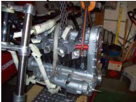
Motoreinbau in den Rahmen
