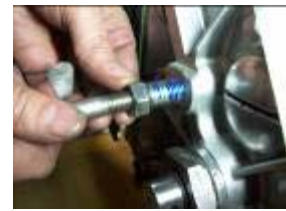
Einsetzen der Buchse mit Loctite
