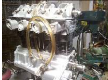
Ausgiebiger Test des Ölkreislaufes durch externen Antrieb der Ölpumpe
