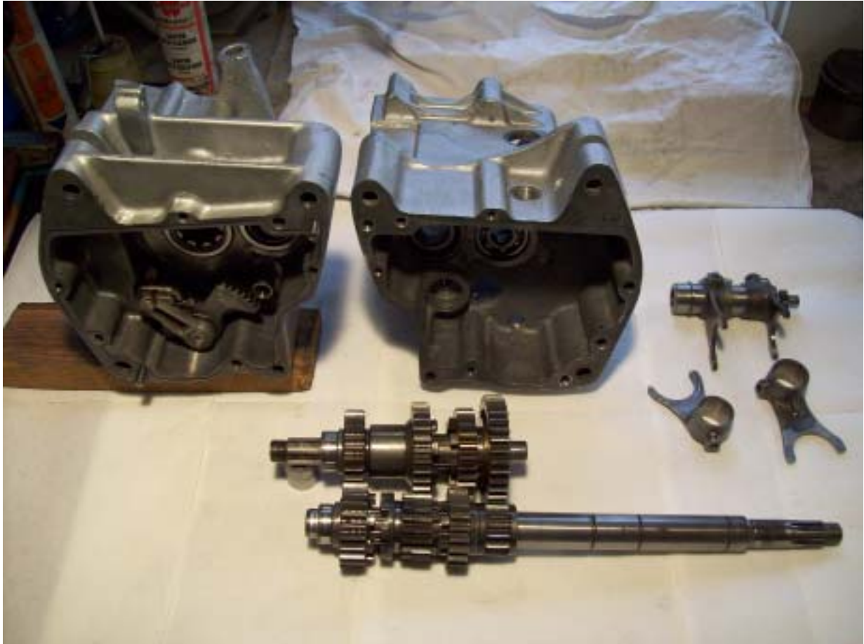
Die Getriebegehäusehälften mit Schaltautomat und Wellen mit Gangrädern Rechts oben auf der Schaltkulisse sitzen die von mir angefertigten neuen Schaltgabeln. Einige Schaltgabeln habe ich in Kleinserie gießen lassen.
