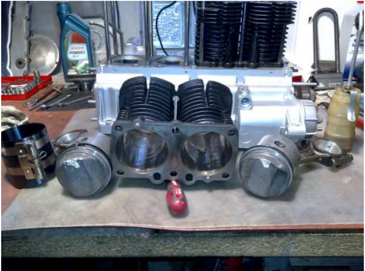
Einziehen der Kolben in die Zylinder
